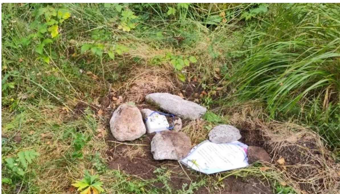
Figure 4. Boîtiers sismiques enterrés à proximité de la Vielha (Espagne) ©Jean Letort
