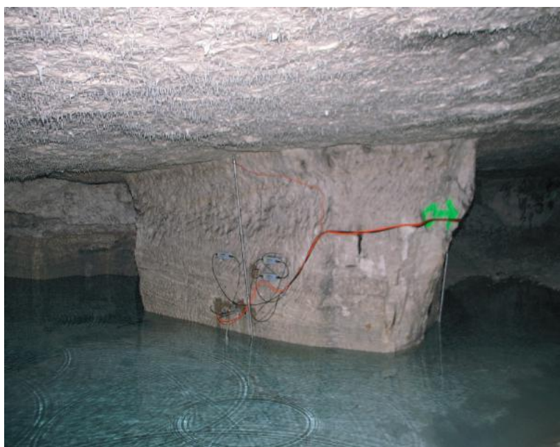
Exemple d'équipements de surveillance en place (Source : INERIS)
